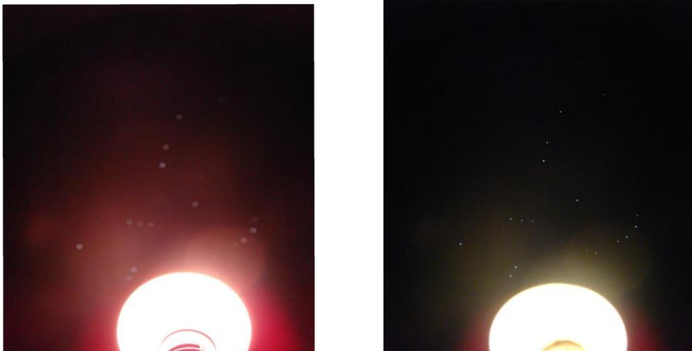
Fig. 17a: Aspecto del cielo con faroles sin blindaje. Fig. 17b: Aspecto del cielo con faroles con blindaje
