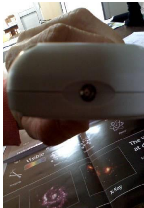
Fig. 10a: Control remoto encendido si lo miramos a simple vista
