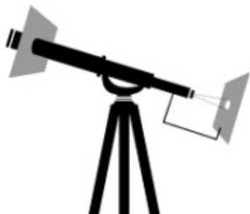
Fig. 10a: Observación solar por proyección con un telescopio (nunca se debe mirar directamente al Sol)
