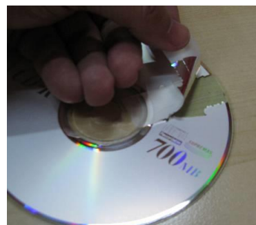
Fig. 3a: Material necesario: DVD, tijeras y caja de cartón Fig. 3b: Retirando la capa metálica del CD, con cinta adhesiva
