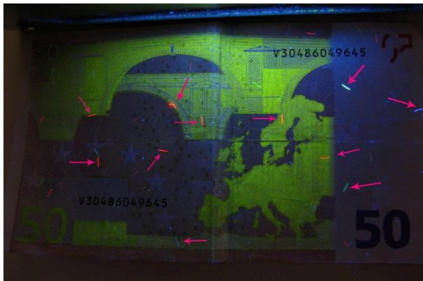
Fig. 18: Un billete de 50 € iluminado con luz UV, muestra unas pequeñas tiras fluorescentes marcadas aquí con flechas..
