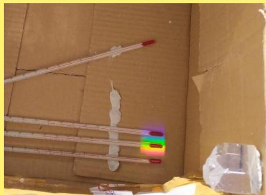
Para reproducir el experimento, necesitaremos un prisma de vidrio, unos termómetros (al menos dos), cinta adhesiva, una caja de cartón y una hoja blanca, si es posible, de material aislante.
