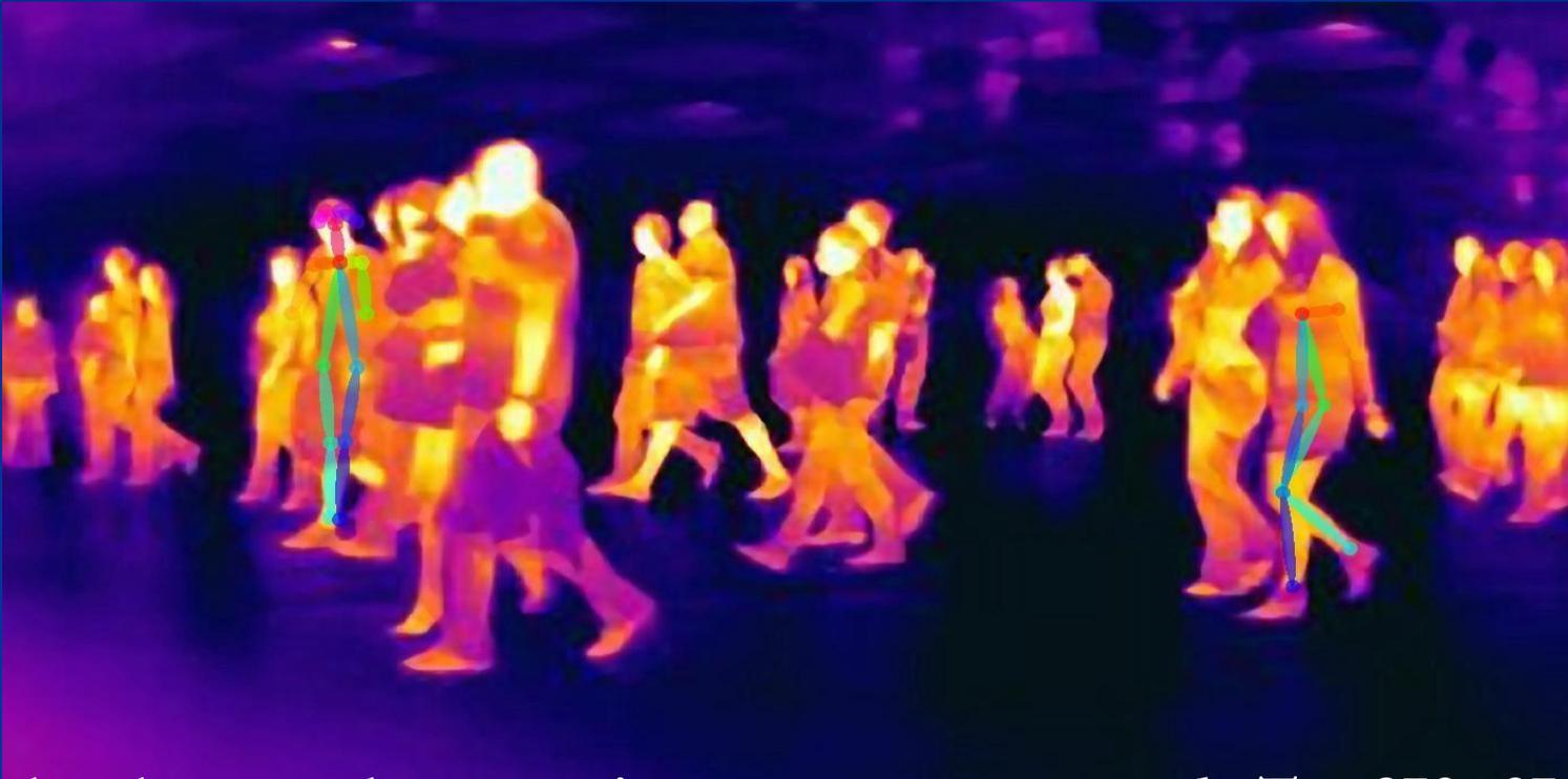
Ejemplo, el cuerpo humano tiene una temperatura de  $T = 273 + 37 = 310$  K. Luego, emite el máximo en  $\lambda_{\max} = 9300$  nm.
