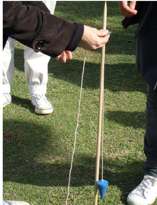
Figuras 1a y 1b. Instalación de la varilla y determinación de perpendicularidad con una plomada
