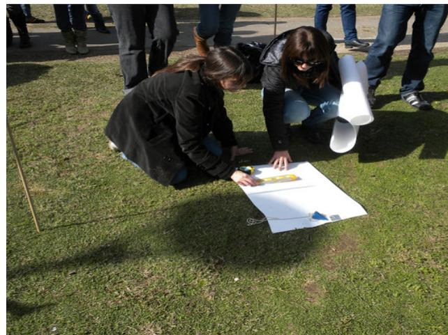
Fig. 3 Determinación de horizontalidad del plano de medición con un nivel
