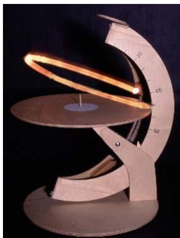
Fig. 27a: Simulador de mayor tamaño hecho en madera. Fig. 27b: Con una cámara fotográfica y una larga exposición es posible simular la trayectoria solar. Fig. 27c: Simulador estelar en madera (Fotos: Sakari Ekko).
