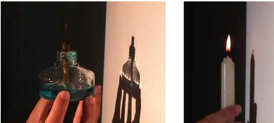
Fig. 18a y 18b: La llama de una lámpara de alcohol o de una vela no produce sombra en la pared.
