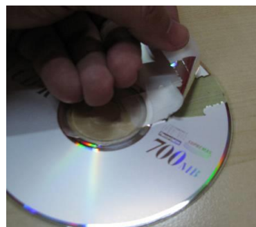
Fig. 3a: Material necesario: DVD, tijeras y caja de cartón Fig. 3b: Retirando la capa metálica del CD, con cinta adhesiva
