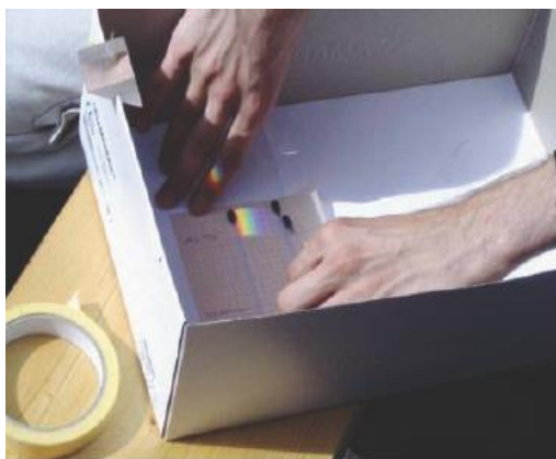
Fig.9a: Situando los tres termómetros, con el bulbo negro, y el espectro en la parte de la sombra.
