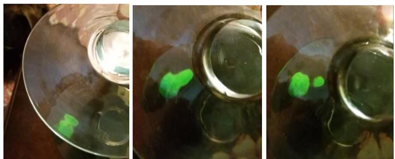
Fig. 31: Moviendo la segunda lente sobre la primera, aparece un punto y después dos, en todos los casos sin mover la primera lente.
