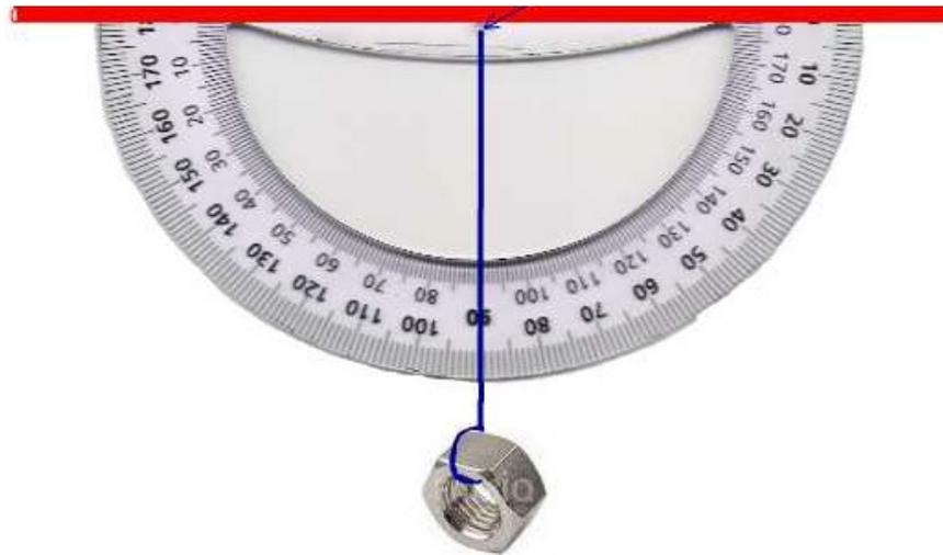
Figura 10: Un ejemplo sencillo de goniómetro vertical.
