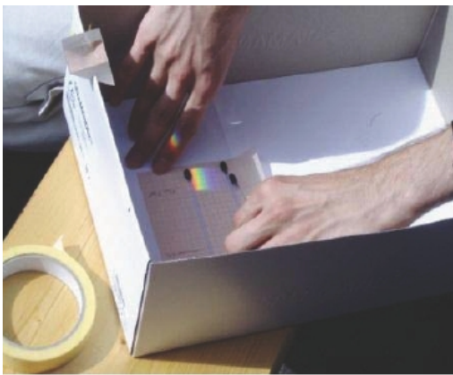
Fig.4: Situando los tres termómetros, con el bulbo negro, y el espectro en la parte de la sombra.
