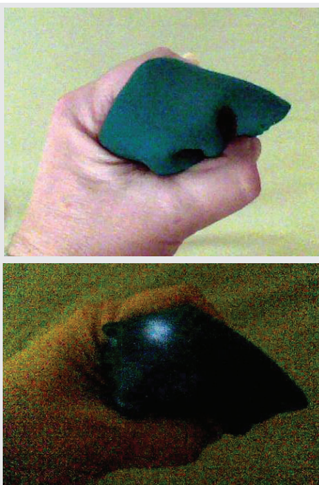
Fig. 12a y 12b: El filtro bloquea totalmente la luz visible pero no la infrarroja.
