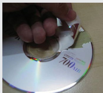
Fig. 3b: Retirando la capa metálica del CD, con cinta adhesiva.
