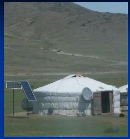
Direction N-S with the inclination = site latitude
