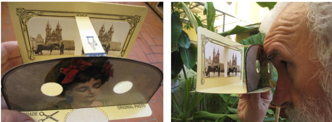
Fig. 1: Dos fotografías son iguales que se miran una por cada ocular. Fig. 2: Miramos a través de los oculares, un ocular para cada ojo, y nuestro cerebro funde las dos imágenes en una única imagen donde se aprecia el relieve que cada foto por separado no tiene.
