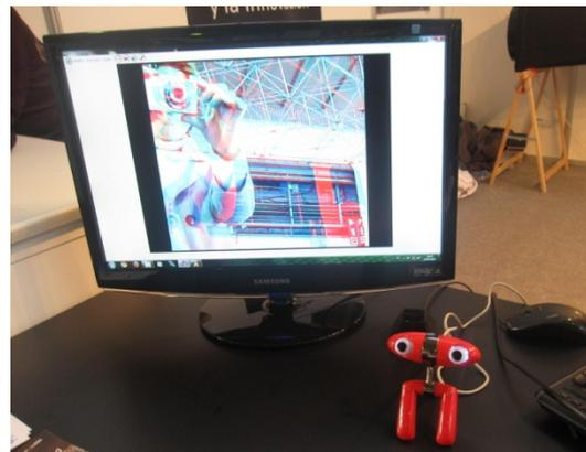
Figuras 4 y 5: Cámara que se puede aplicar a un ordenador y que permite obtener imágenes en 3D
