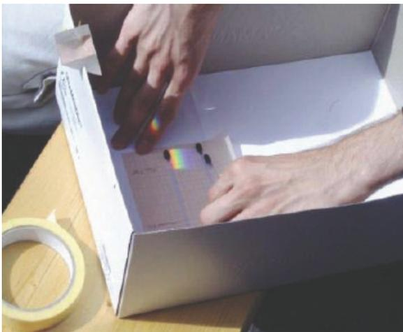
Gambar 9a: Letakkan 3 termometer, dengan ujung hitam, dan spektrum pada sisi bayangan.
