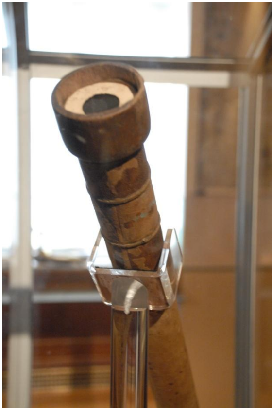
Fig. 7a: Unul dintre telescoapele lui Galileo care au supraviețuit în timp a ajuns la Franklin Institute în Philadelphia în 2009, cu ocazia primei vizite în Statele Unite. De reținut că partea exterioară a lentilei este acoperită cu un inel de carton. Ascunzându-se partea exterioară a lentilei, care era partea cea mai puțin corectă, Galileo a îmbunătățit calitatea imaginilor sale. (Foto: Jay M. Pasachoff). Fig. 7b: O pagină din cartea lui Galileo Sidereus Nuncius (Mesagerul stelelor), publicată în anul 1610, prezintă o gravură a Lunii. Cartea a fost scrisă în limba latină, limba profesorilor din Europa. Cartea include o abordare extensivă a mișcării relative a celor patru luni principale ale lui Jupiter.
