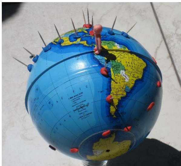
Fig. 6b: Podemos colocar um boneco indicando a nossa posição e pedaços de argila para indicar a linha de divisão luz/sombra. Com a passagem das horas esta linha de separação luz/sombra mudará. Também podem ser usados pedaços de palitos para estudar as suas sombras.
