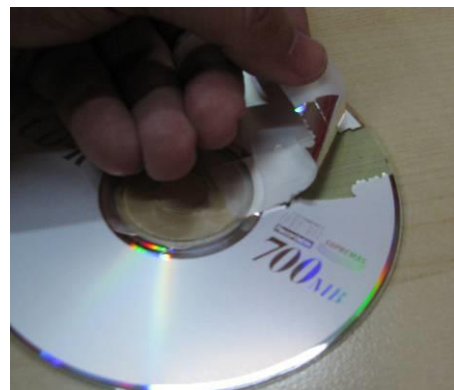
Gambar 3b: Melepas lapisan metal pada CD dengan selotip.
