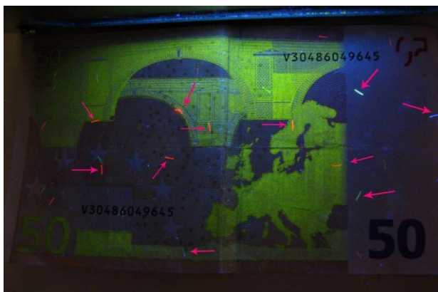
Gambar 17: Uang pecahan 50 euro yang dilihat dengan bantuan sinar UV menunjukkan garis berpendar yang ditandai dengan garis panah.
