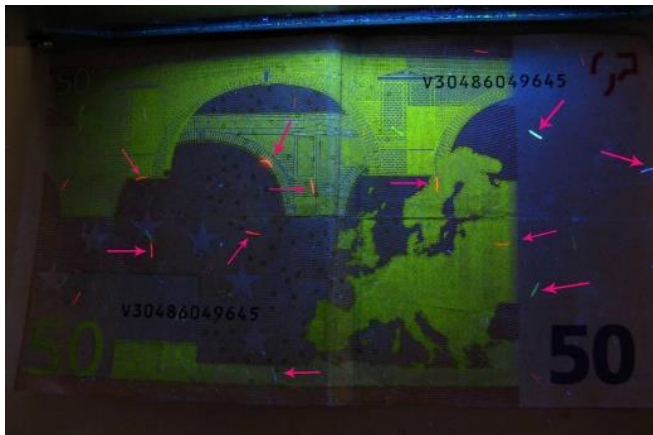
Fig. 19: Uma nota de 50 € iluminada com luz UV mostra pequenas tiras fluorescentes marcadas com setas.
