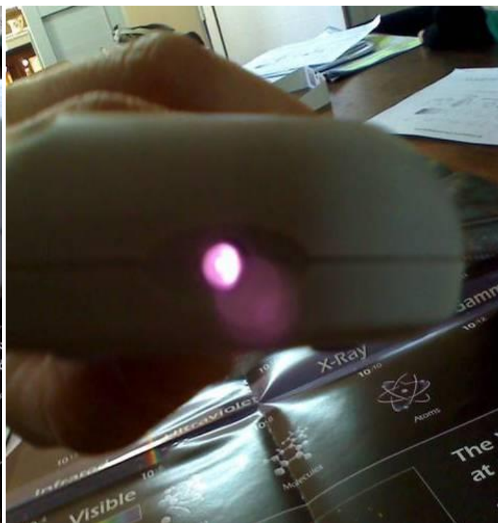
Fig. 10b: Comando à distância ligado e observado através do telemóvel.
