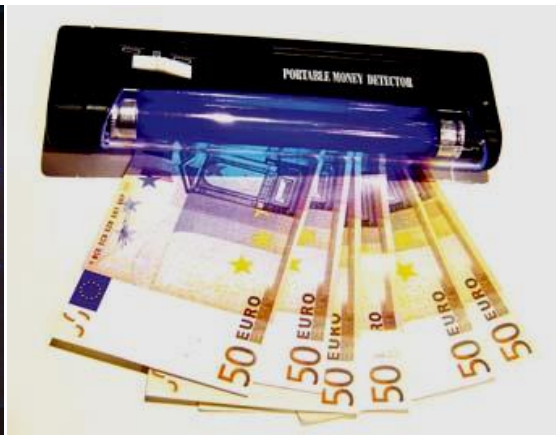
Fig. 20: Detetor de notas falsas que usa luz ultravioleta.
