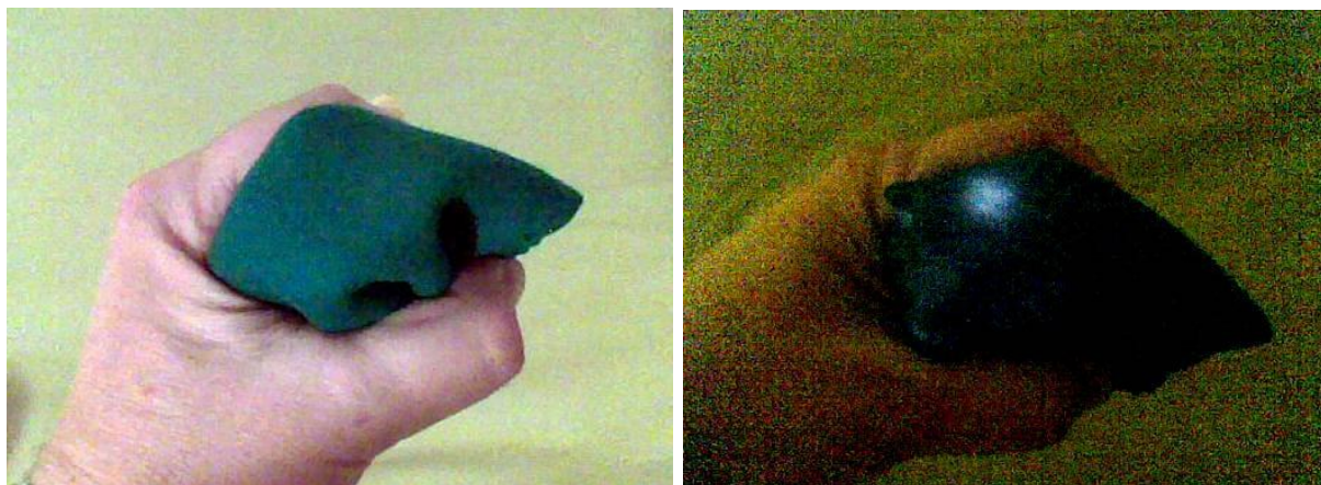
Fig. 12a e 12b: O feltro bloqueia totalmente a luz visível, mas não a infravermelha.
