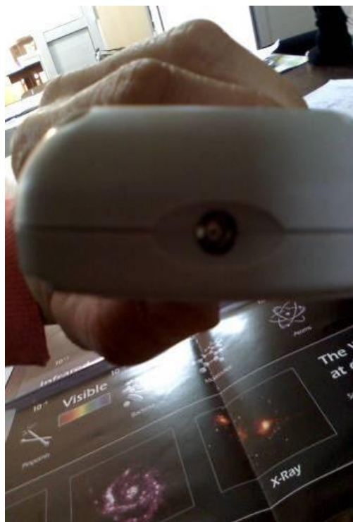
Fig. 10a: Comando à distância ligado e observado a olho nu.
