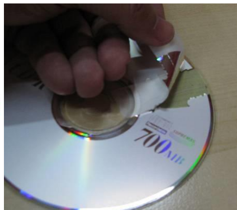
Fig. 3b: Retirando a capa metálica do CD, com fita adesiva.
