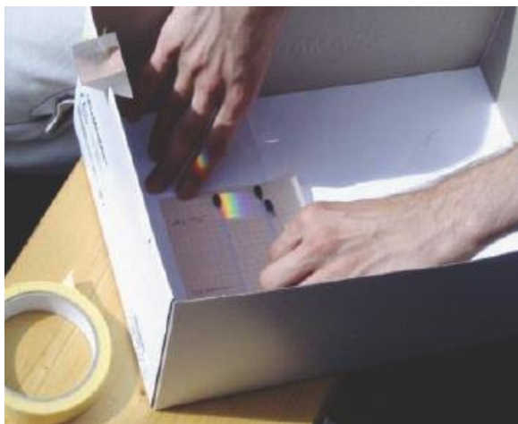
Fig. 9a: Colocando os três termómetros, com os bulbos pretos, e o espectro na sombra.
