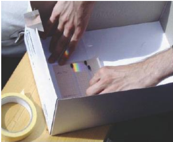
Fig.16a: Cele trei termometre se fixează cu bulbul, în partea umbră a cutiei
