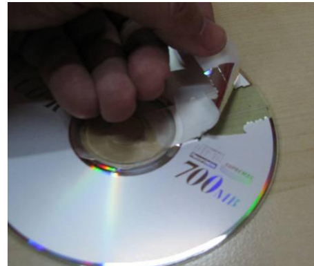
Fig. 10b: Îndepărtarea stratului metalic de pe CD cu ajutorul unei benzi adezive
