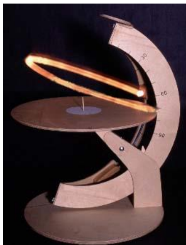
Fig. 27a: Simulador de major grandària fet en fusta. Fig. 27b: Amb una càmera fotogràfica i una llarga exposició és possible simular la trajectòria solar. Fig. 27c: Simulador estel·lar en fusta (Fotos: Sakari Ekko).
