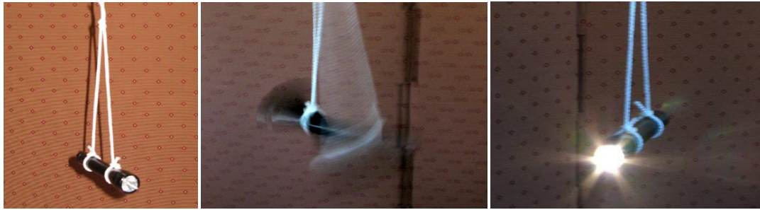
Fig. 17a: Assemblage. Fig. 17b: Faire tourner la lampe de poche. Fig.17c: En tournant, on observe le faisceau lumineux de manière périodique
