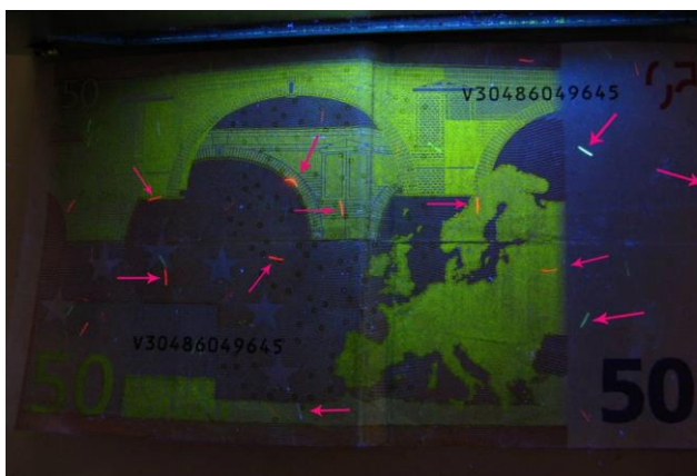
Fig. 18: Une note de 50 € illuminée par des rayons UV, montre de petites bandes fluorescentes marquées ici par des flèches.
