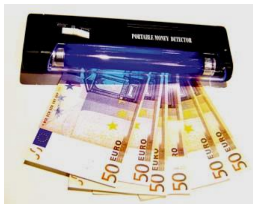
Fig. 18: Detector de bitllets falsos, que fa servir llum ultraviolada .
