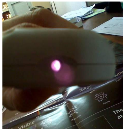
Fig. 10b: Control remot si ho mirem a través del telèfon mòbil
