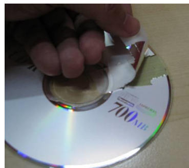
Fig. 3a: Material necessari: DVD, tisores i caixa de cartró Fig. 3b: Retirant la capa metàl·lica de el CD, amb cinta adhesiva
