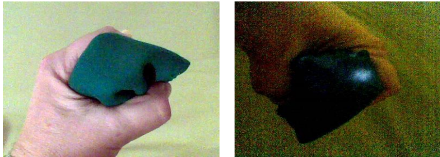
Рис. 12a and 12b: Войлок полностью блокирует видимый свет, но не инфракрасный.
