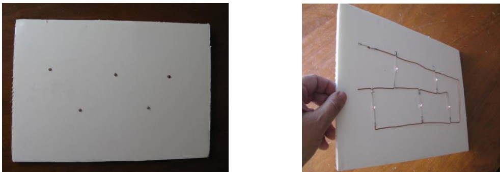
Рис. 13a и 13b: Кассиопея сделанная из инфракрасных светодиодов. Они соединены параллельно.
