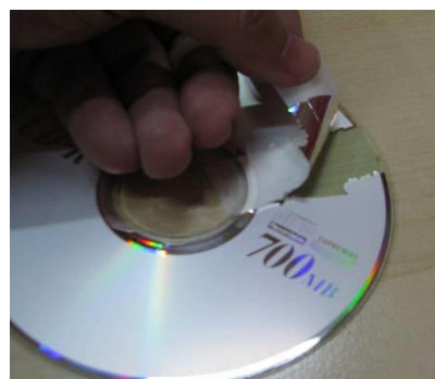
Рис. 3б: Удаление металлического слоя компакт-диска с помощью скотча.
