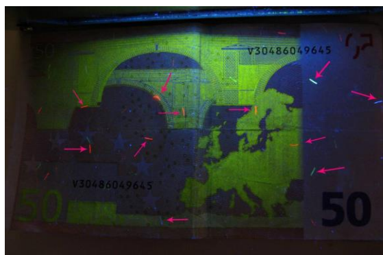
Рис. 17: Банкнота в 50 €, освещенная УФ светом, показывает маленькие флуоресцентные полоски, отмеченные здесь стрелками, Рис. 18: Детектор подделок, использующий ультрафиолетовый свет.
