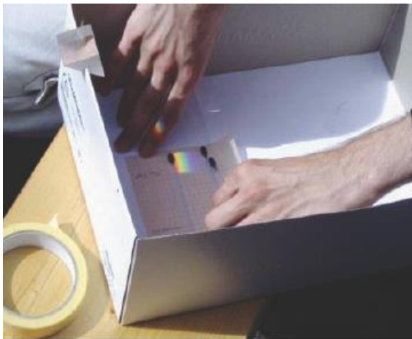
Рис.9а: Размещаем три термометра с черной частью и спектром в теньюую часть.
