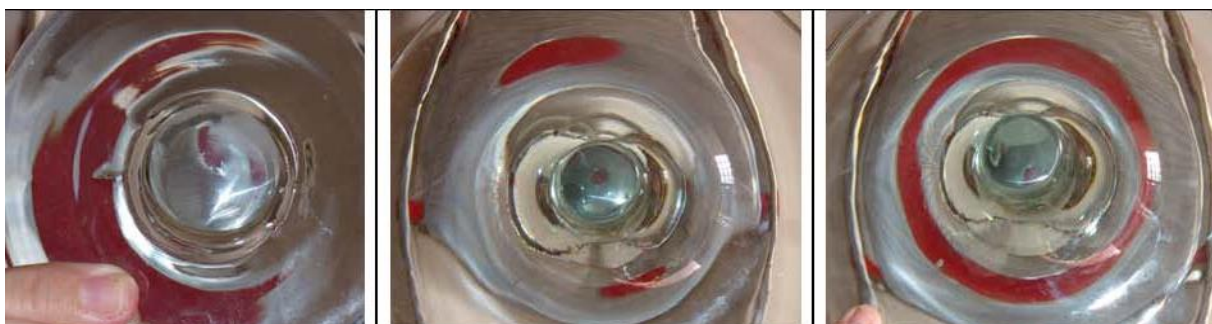
Fig. 24a, 24b et 24c: le pied en verre peut simuler diverses formes réalisées par des lentilles gravitationnelles: des segments d'arc, des images de points et des anneaux d'Einstein.
