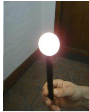
Fig. 15b: Lanterna cu mingea de tenis de masă simulând un corp de iluminat stradal
