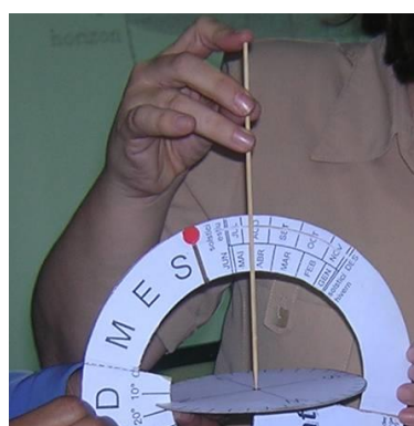
Fig. 26a: Umbră mică (Soarele este aproape la zenit într-un loc aproape de ecuator). Fig. 26b: Simularea Soarelui la zenit în Honduras (latitudine 15^\circ N).
