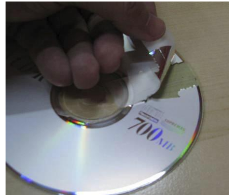
Fig. 3b: Îndepărtarea stratului metalic de pe CD cu ajutorul unei benzi adezive
