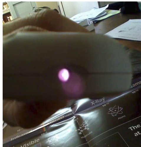
Fig. 10b Telecomanda activată, cu ajutorul camerei foto
