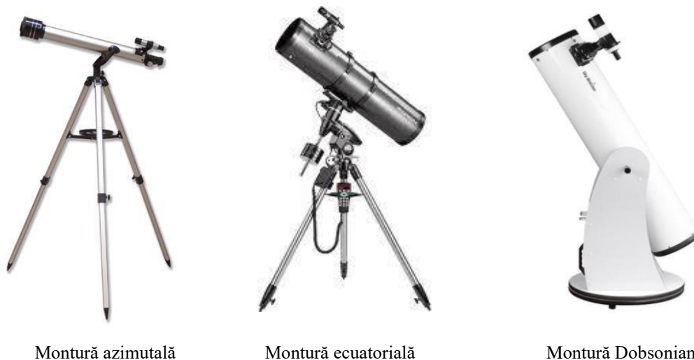
Fig.6: Diferite monturi pentru suporturi de telescop
