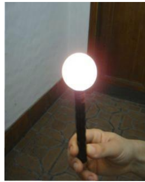
Fig. 15b: Lanterna cu mingea de tenis de masă simulând un corp de iluminat stradal
