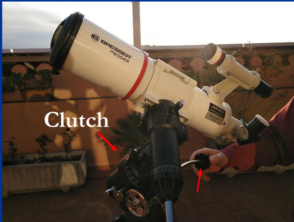
ردیابی با استفاده از چرخ دنده انعطاف پذیر محور قطبی
