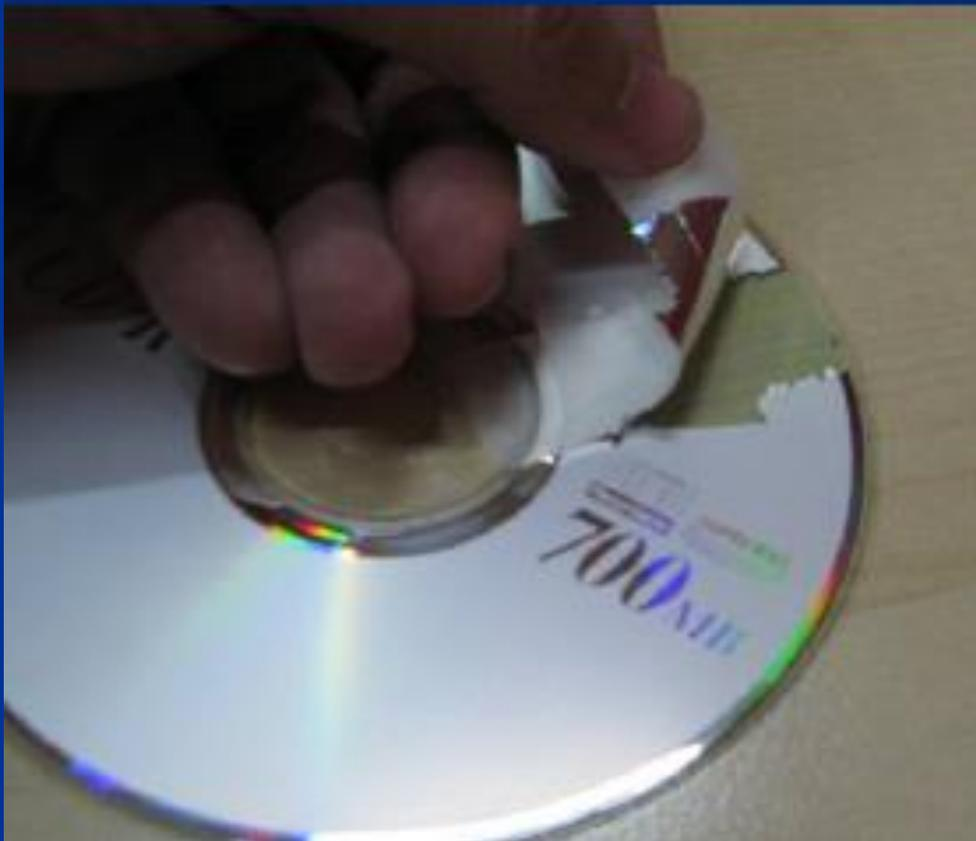
Menghilangkan lapisan logam dari CD (CD yang masih berwarna putih tidak dapat digunakan) dengan menggores dan menariknya dengan selotip.
