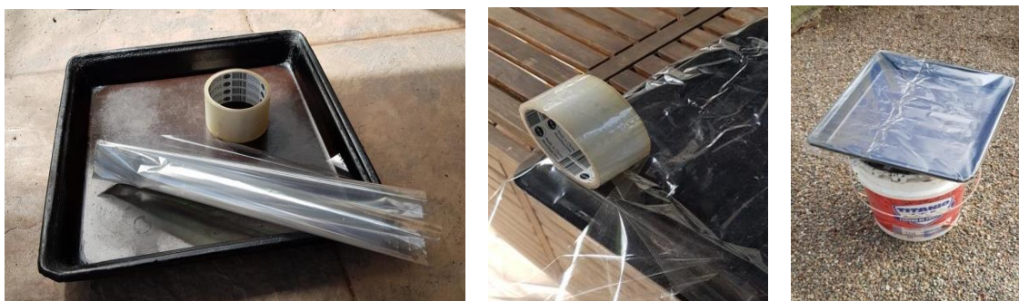
चित्र 28a: ट्रे, सेलोफेन पेपर और ग्लूइंग के लिए टेप, चित्र 28b: ट्रे के पीछे सेलोफेन पेपर को चिपकाना, चित्र 28c: बगीचे में स्थापित माइक्रोमिटेराइट "ट्रेप"।
