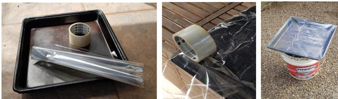
図 28a:トレイ、セロハン紙、接着用テープ、図 28b:トレイの裏側にセロハン紙を接着、図 28c:庭に設置された微小隕石「トラップ」。
