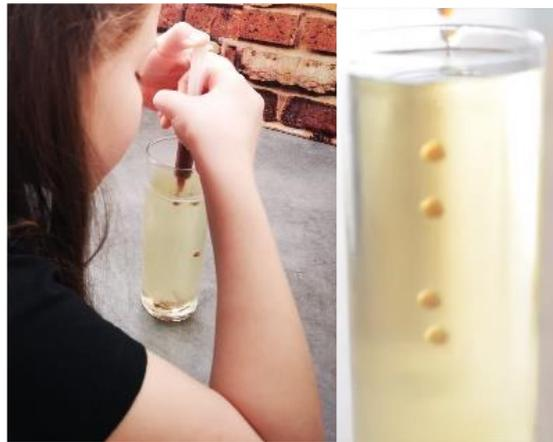
図 24a:注射器で滴下、図 24b:球体が形成されるカラム。
