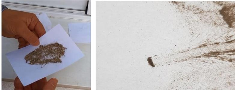
図 26a および 26b:磁石を紙の下に通すことで、強磁性体をドラッグします
