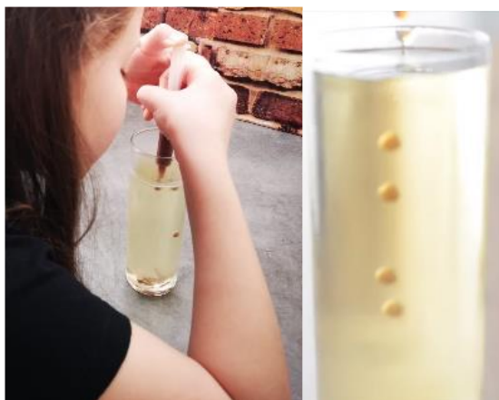
Рис.24 а: Капельница с помощью шприца, Рис.24б: Колонна, в которой формируются сферы.
