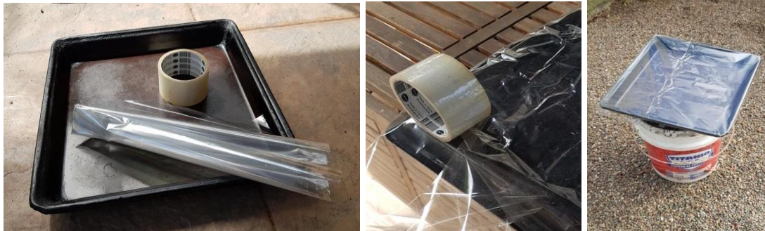
Fig. 28a: Tray, ցելոֆանի թուղթ եւ ժապավեն՝ gluing համար, Fig. 28b: Gluing the cellophane paper on the back of the սկուտեղ, Fig. 28c: Micrometeorite «trap» installed in the garden.
