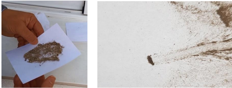
Fig. 26a y 26b: Al pasar el imán por debajo de la hoja de papel, arrastra el material ferromagnético
