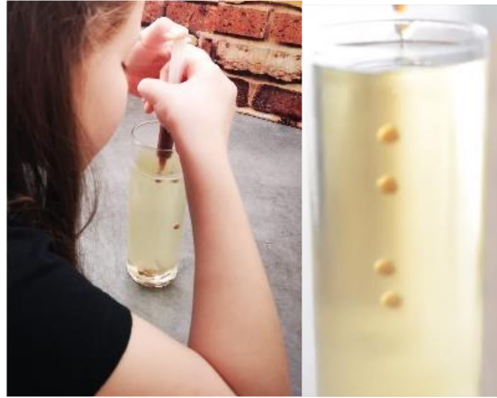
Fig.24a: Realitzant el degoteig amb una xeringa, Fig. 24b: Columna d' on es formen les esferes.
