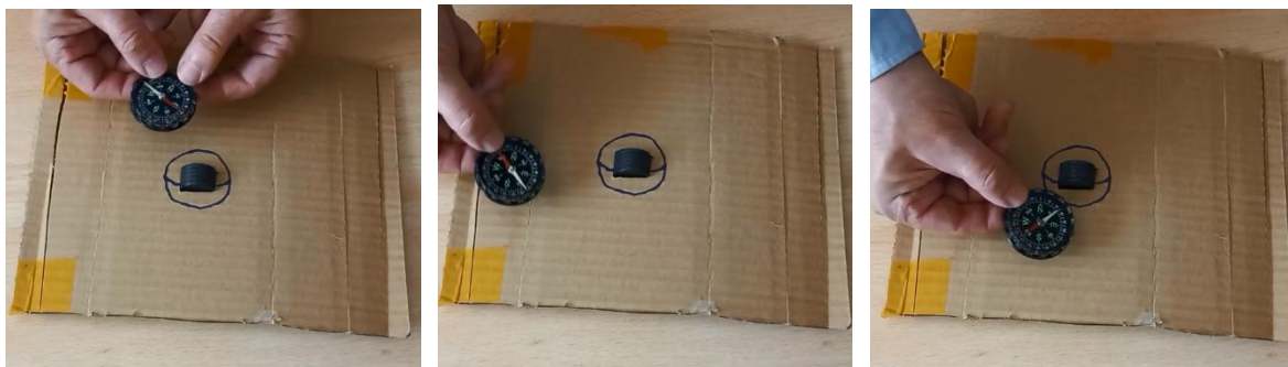
Fig. 17a, 17b, 17c: Amb una brúixola, les línies de camp es "dibuixen" (l'agulla de la brúixola sempre és tangent a les línies de camp).
