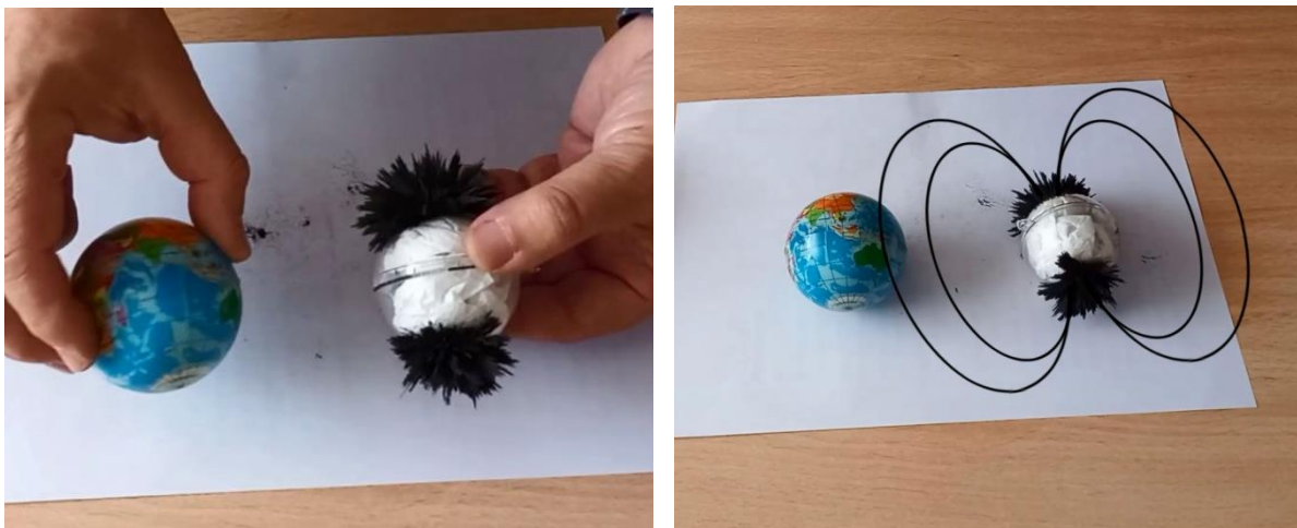
Fig. 19a i 19b: Amb llimadures de ferro es visualitzen les línies de camp a les zones polars. És en aquestes zones on es produeixen les aurores.
