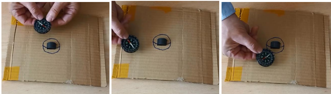
图 17a, 17b, 17c：使用指南针，“绘制”场线（罗盘指针始终与场线相切）。
