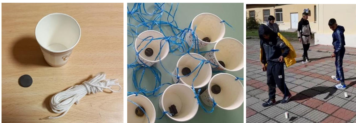
图 29a 和 29b：玻璃用线和内部的小磁铁绑住。图 29c：学生使用玻璃，寻找微陨石。
