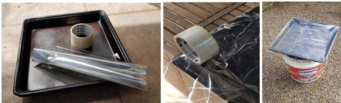
图 28a：托盘、玻璃纸和胶带，图 28b：将玻璃纸粘在托盘背面，图 28c：安装在花园中的微陨石“陷阱”
