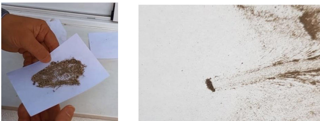
图 26a 和 26b：通过将磁铁穿过纸片下方，拖动铁磁材料
