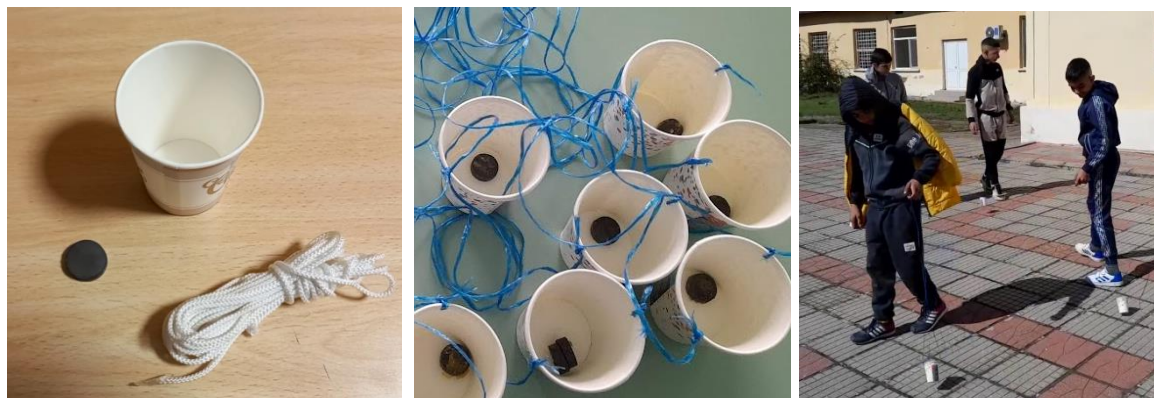
Kuvat 29a ja 29b: Lasi sidottu langalla ja pienellä magneetilla. Kohde 29c: Opiskelija käyttää lasia ja etsii mikrometeoriitteja.
