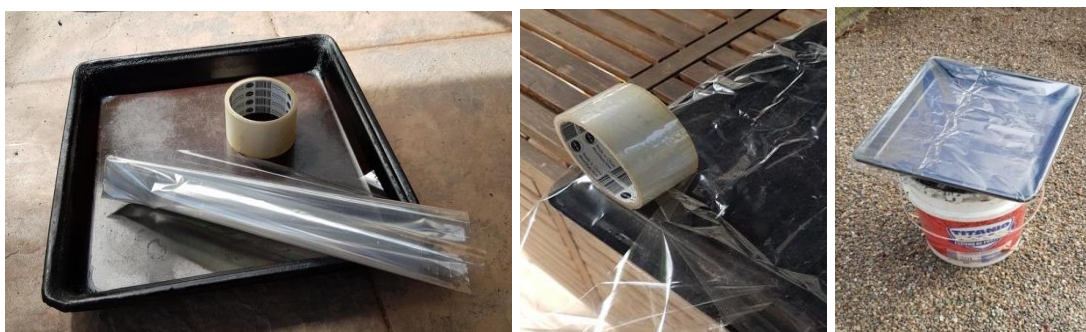
Kohde 28a: Tarjotin, sellofaanipaperi ja teippi liimaamista varten, Kuva 28b: Sellofaanipaperin liimaaminen lokeron takaosaan, Kuva 28c: Mikrometeoriitin "ansa" asennettuna puutarhaan.
