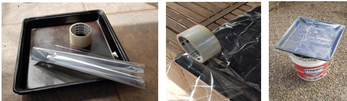
Fig. 28a : Plateau, papier cellophane et ruban adhésif pour collage, Fig. 28b : Collage du papier cellophane au dos du plateau, Fig. 28c : « piège » à micrométéorites installé dans le jardin.
