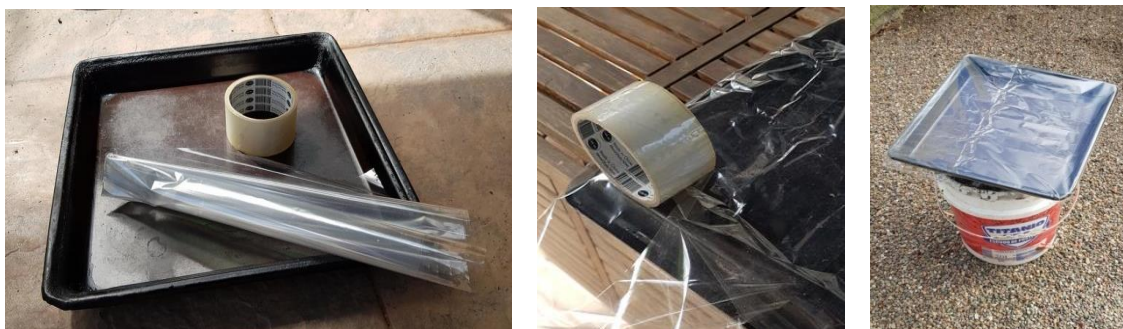
Εικ. 28α: Δίσκος, χαρτί σελοφάν και ταινία για κόλληση, Εικ. 28β: Κόλληση του χαρτιού σελοφάν στο πίσω μέρος του δίσκου, Εικ. 28γ: « παγίδα» μικρομετεωρίτη εγκατεστημένη στον κήπο.
