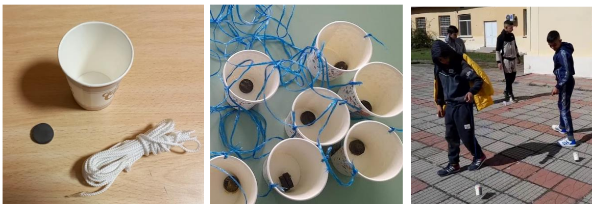
Εικ. 29α και 29β: Το γυαλί δεμένο με μια κλωστή και ένα μικρό μαγνήτη μέσα. Εικ. 29γ: Μαθητής που χρησιμοποιεί το γυαλί, ψάχνοντας για τους μικρομετεωρίτες.
