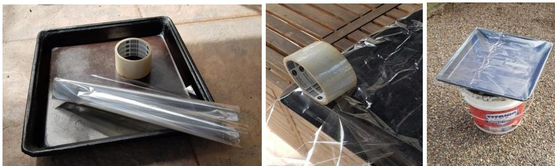
Gambar 28a: Baki, kertas plastik dan selotip untuk perekatan, Gambar 28b: Menempelkan kertas plastik di bagian belakang baki, Gambar 28c: " perangkap" mikrometeorit dipasang di kebun.
