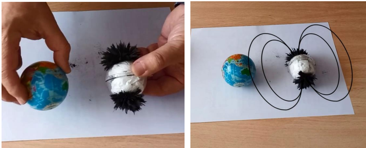
Fig. 19a ir 19b: Naudojant geležies drožles, vizualizuojamos lauko linijos poliarinėse srityse. Būtent šiose vietose atsiranda auroros.
