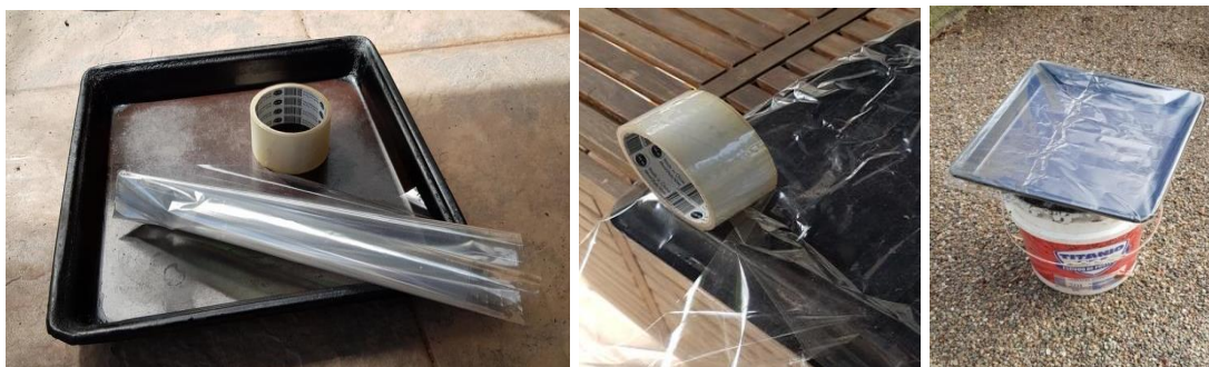
Zīm. 28a: Paplāte, celofāna papīrs un lente līmēšanai, 28.b att.: Celofāna papīra līmēšana paplātes aizmugurē, 28.c att.: Dārzā uzstādīts mikrometeorīta "slazds".
