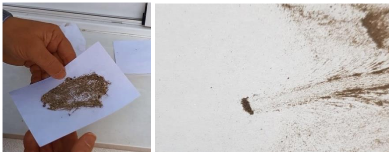
26.a un 26.b attēls: Izlaižot magnētu zem papīra lapas, velciet feromagnētisko materiālu
