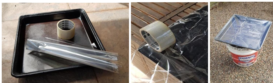
Fig. 28a: Трау, целофан цаас болон цавуугаар наах тууз, Fig. 28b: Целофан цаасыг тавиурын ар талд цавуугаар нь цавчсан нь, Fig. 28c: Цэцэрлэгт суурилуулсан Микрометеорит "хавхлага".
