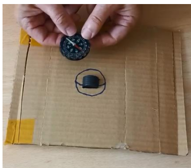
Fig. 17a, 17b, 17c: Луужинтай бол талбайн шугамыг "татдаг" (луужин зүү нь үргэлж талбайн шугамтай таардаг).
