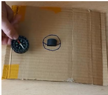
Fig. 17a, 17b, 17c: Луужинтай бол талбайн шугамыг "татдаг" (луужин зүү нь үргэлж талбайн шугамтай таардаг).
