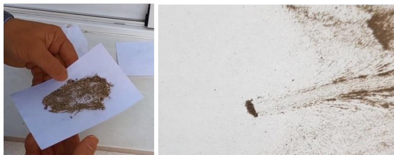
Fig. 26a болон 26b: Цаасан доорх соронзыг дамжуулснаар ферромагнет материал чирч
