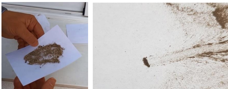
Fig. 26a și 26b: Prin trecerea magnetului sub foaia de hârtie, trageți materialul feromagnetic
