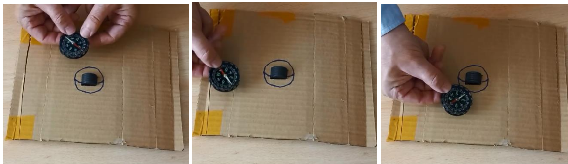
Fig. 17a, 17b, 17c: Cu busolă, liniile de câmp sunt "desenate" (acul busolei este întotdeauna tangent la liniile de câmp).
