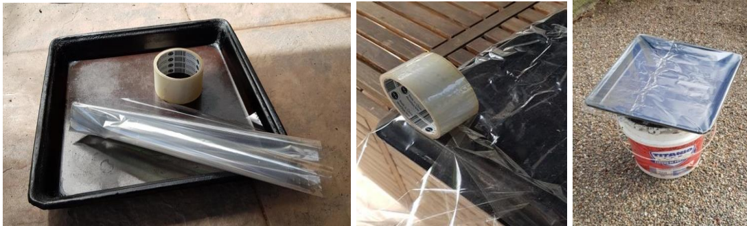
Şekil 28a: Tepsi, selofan kağıdı ve yapıştırma için bant, Şekil 28b: Selofan kağıdının tepsinin arkasına yapıştırılması, Şekil 28c: Bahçeye yerleştirilmiş mikrometeorit "tuzak".
