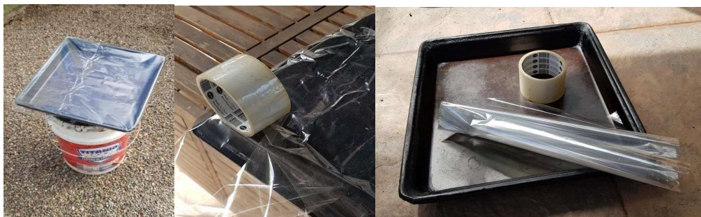
۲۸a: سینی، سلفون و نوار، ۲۸b: چسباندن سلفون به پشت سینی، ۲۸c: تله میکروشهاب سنگی که در حیاط یا پشت بام قرار داده شده است.
