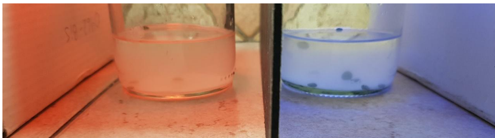
Fig. 29a y Fig. 29b: La solución con las lámparas de diferente color mostrando como ascienden los discos de forma diferente en cada caso
