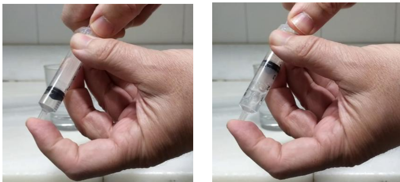
Fig. 22a: Agua caliente a 80° en el interior de la jeringuilla antes de tirar del émbolo. Fig. 22b: Al tirar del émbolo el agua empieza a hervir sin estar a 100°
